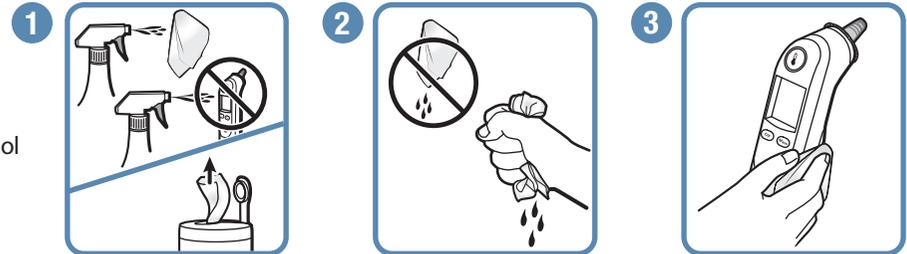
Trocken reiben. 5 Minuten warten, damit sie vollständig trocknen können. Sicherstellen, dass das Thermometergehäuse vor der Verwendung trocken ist.
