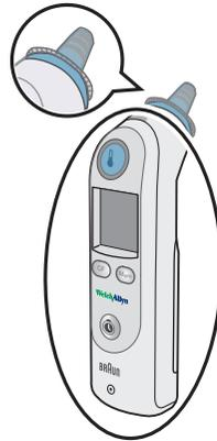
**HINWEIS** Vor der Reinigung eine neue Sondenhülle auf das Thermometer stecken.
